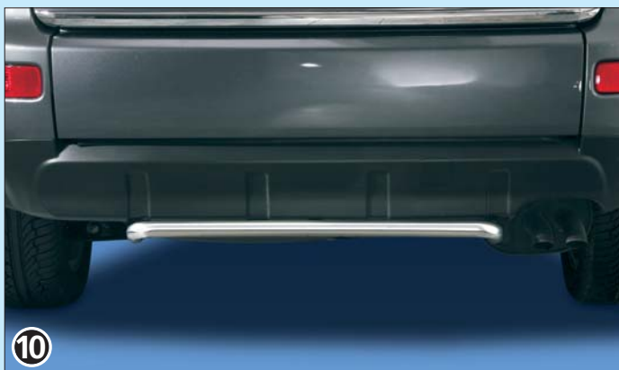
10 Bumper rear 35mm (not compatible with tow-bar, but with parking sensors) Heckstoßstange 35mm (nicht kompatibel mit Anhängerkupplung, aber mit Parksensoren) Stainless steel / Edelstahl 12D 4038
