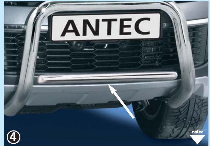
④ EU-horizontal pipe 42mm (EU-certificate valid in combination with 12D4113 only) EU-Querrohr 42mm (EU-Zertifikat nur gültig mit 12D4113) Stainless steel / Edelstahl
